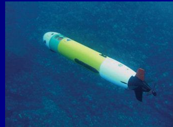
Подводный робот REMUS 100 (Hydroid) создано 200 экз.
