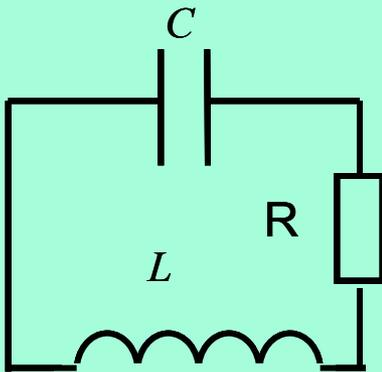
*Реальный колебательный контур кроме катушки индуктивности и конденсатора содержит активное сопротивление  $R$  а также сопротивление проводов катушки и соединительных проводов.*
