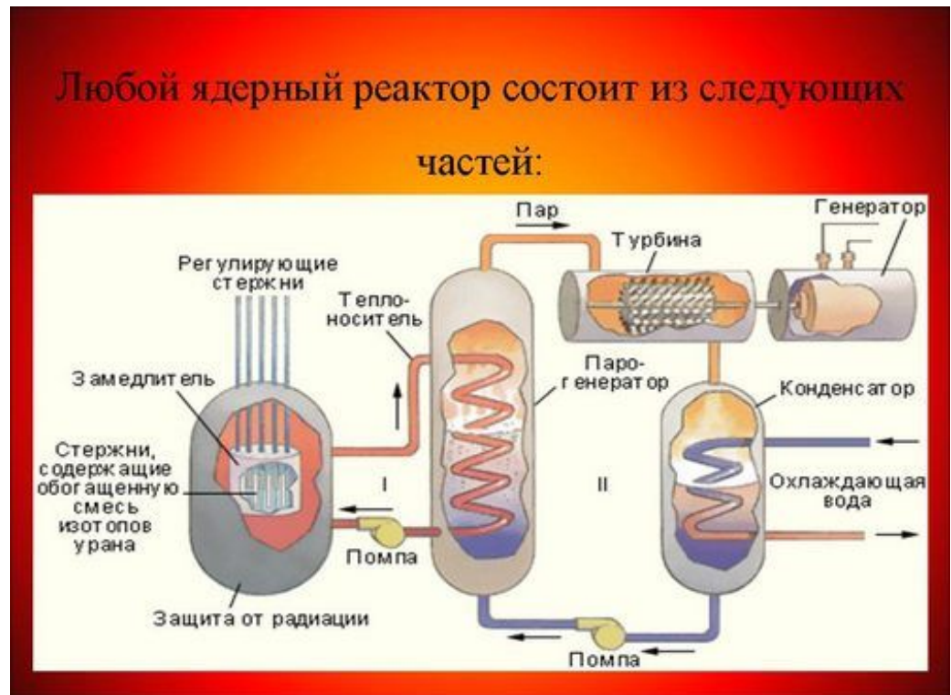
Основные элементы ядерного реактора
