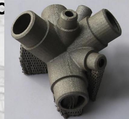
Конструкции спроектированные, рассчитанные и изготовленные методом селективного лазерного спекания (аддитивная
