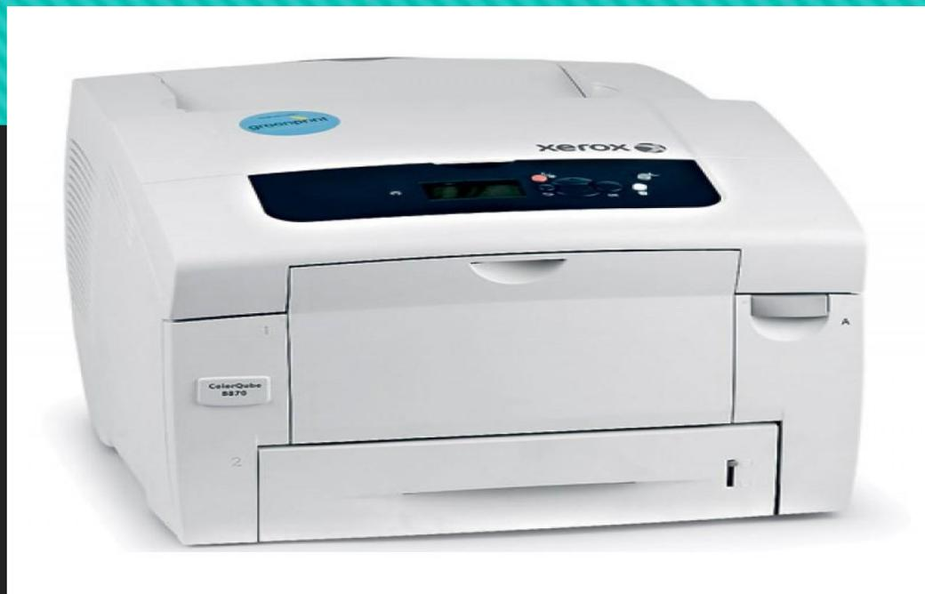
Технология переноса расплавленных восковых чернил через отверстия, диаметр которых меньше толщины человеческого волоса, из неподвижных печатных головок на вращающийся барабан, с которого затем изображение переносится на носитель.
