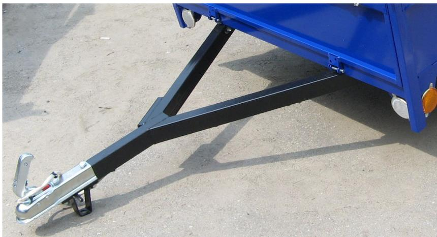
V-образное дышло повышает прочность и долговечность прицепа, уменьшает раскачивание кузова на неровных дорогах
