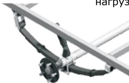
Дополнительные резиновые рессоры сжатия вступают в действие при значительных прогибах основных рессор и повышают жесткость подвески при увеличении нагрузки на ось прицепа
