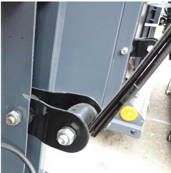
Рессоры шарнирно соединены с рамой прицепа, что обеспечивает плавность хода подвески и увеличивает срок ее службы, а также снижает вибрации и ударные нагрузки, передаваемые на фаркоп автомобиля
