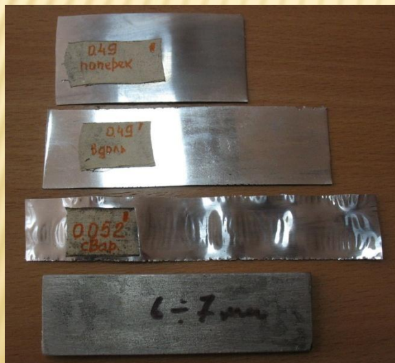
Образцы до и после прокатки
