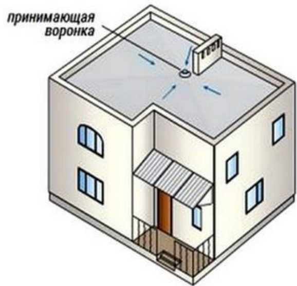
Схемы водоотводов дождевых стоков с рулонной кровли в домах с крышами без чердаков
