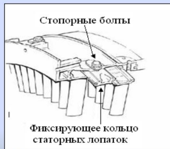
Методы крепления неподвижных направляющих лопаток на статоре
