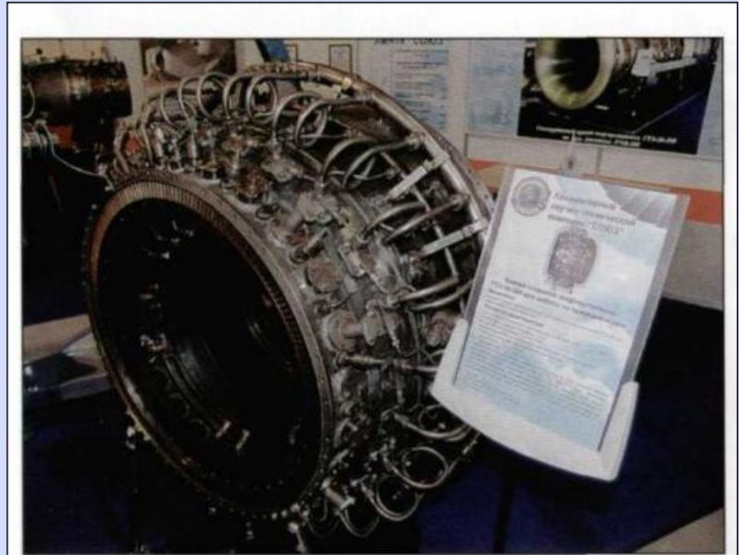
Прямоточная кольцевая камера сгорания, созданная на базе камеры сгорания авиационного двигателя Р79В-300, с впрыском воды для подавления оксидов азота
