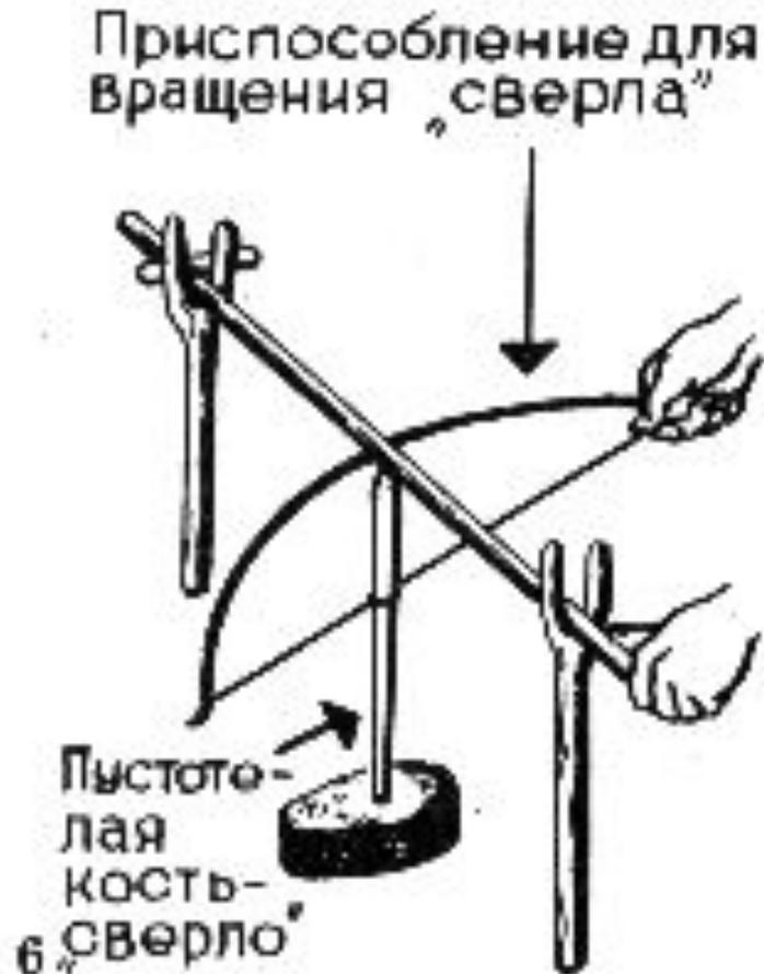
**Древние люди освоили довольно сложные для того уровня технологии. На слайде изображен первобытный сверлильный станок. При его помощи люди сверлили отверстия в каменных топорах и затем вставляли в них древко.**
