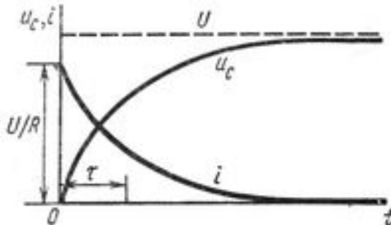
**Разрядка конденсатора.** Если переключатель  $\Pi$  включить в положение 2, то заряженный конденсатор начнет разряжаться на резистор  $R$ . Принимая  $u'_C = 0$  и находя из начальных условий  $u_C$  (при  $t = 0, u_C = U_C$ ), а постоянная интегрирования  $A = U_C$  получим, что напряжение на конденсаторе равно
