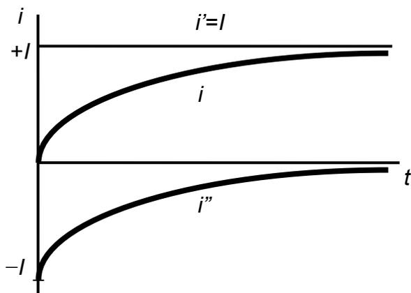
Из начальных условий с учетом первого закона коммутации определяем постоянную интегрирования  $A$ : при  $t = 0$  ток в цепи равен нулю.
