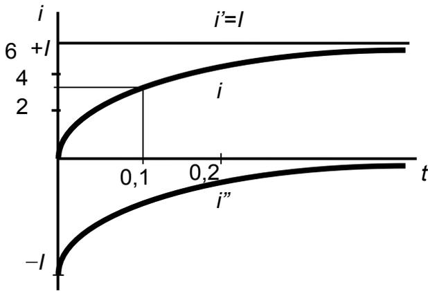
Изменение токов в цепи с последовательным соединением элементов с  $R$  и  $L$  при включении цепи на постоянное напряжение
