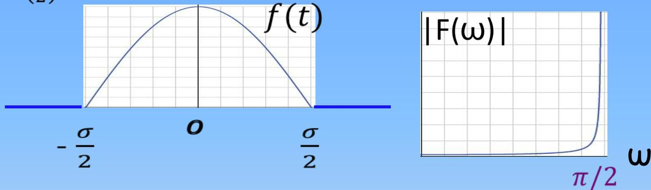
Косинусоидальный импульс и его амплитудный спектр
