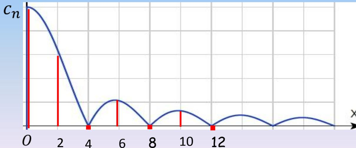
Замечаем, что при увеличении периода импульсы всё дальше отстоят друг от друга, линии спектра сближаются. В пределе при  $l \rightarrow \infty$  ( $\sigma = 1$  остается прежним) функция  $f(t)$  сводится к одиночному импульсу
