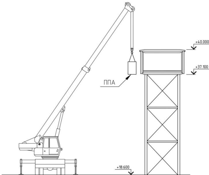
Схема строповки ППА
