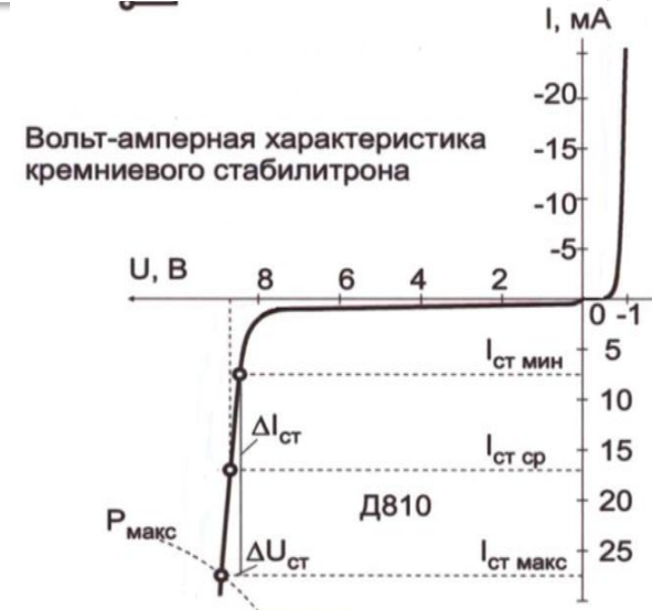
Вольт амперная характеристика стабилитрона
