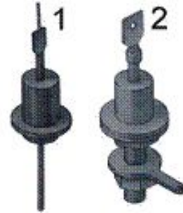
1-маломощный стабилитрон; 2-мощный стабилитрон.
