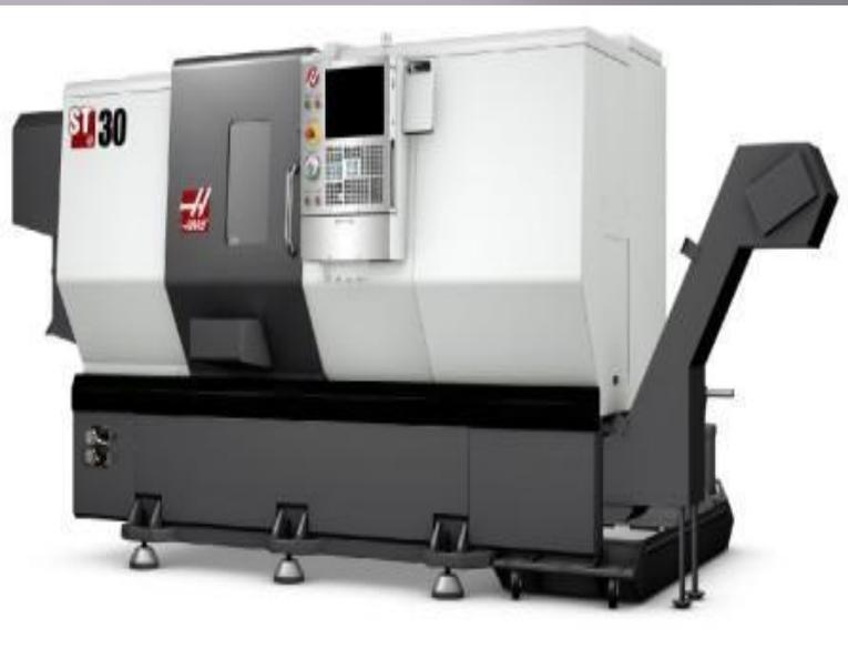
Универсальный токарный станок HAAS ST-30 повышенной точности предназначен для выполнения самых разнообразных токарных, резбонарезных и сверлильных работ повышенной точности.
