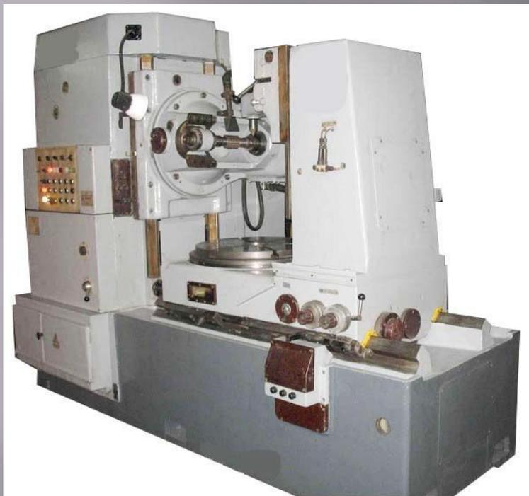
Станки модели 50а30п предназначены для нарезания прямозубых и косозубых цилиндрических колес, червячных колес, звездочек, для прорезания впадин на коротких шлицевых валиках червячными фрезами методом обкатки.
