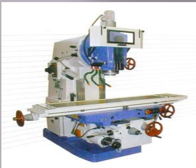
Станок фрезерный вертикальный модели VM127 предназначен для фрезерования всевозможных деталей из стали, чугуна и цветных металлов и сплавов торцовыми, концевыми, цилиндрическими, радиусными и другими фрезами в условиях индивидуального, мелкосерийного и серийного производства.
