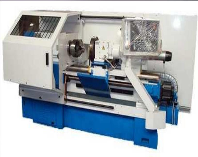
**16А20 токарный станок с ЧПУ** - станок патронно-центровой с числовым программным управлением (ЧПУ), предназначен для токарной обработки деталей типа тел вращения в замкнутом полуавтоматическом цикле.
