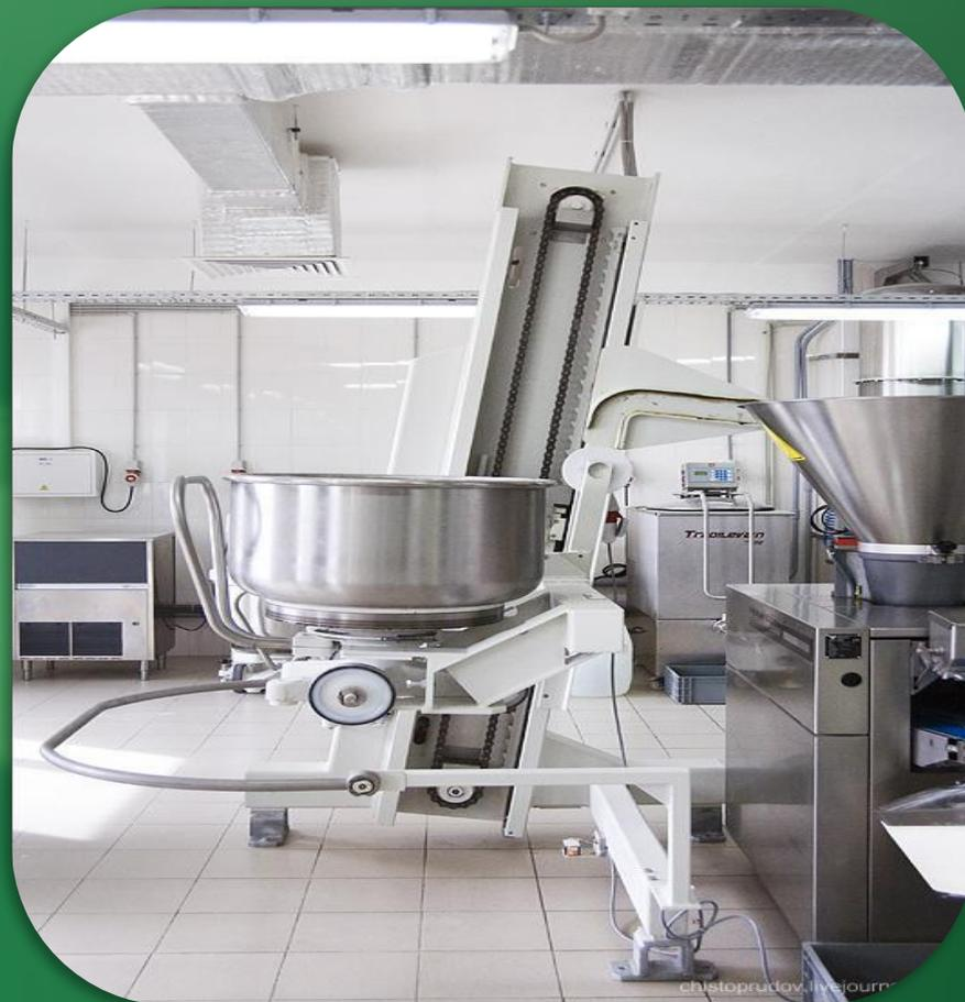
Он поднимает и опрокидывает дежу, тесто загружается в машину.
