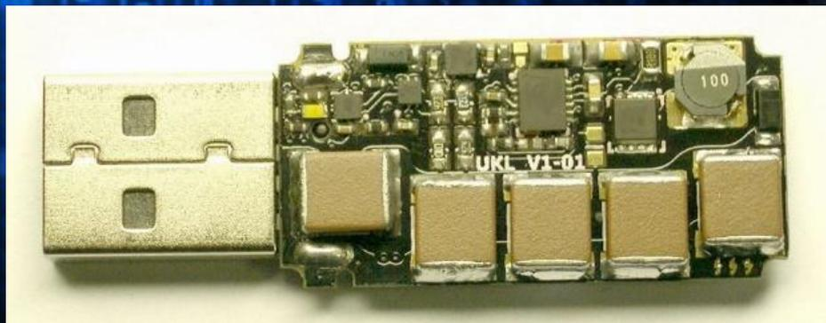
**BadUSB** – метод атаки, включающий перепрошивку USB-устройства так, чтобы оно воспринималось компьютером как иное устройство. Например, USB-флешку компьютер будет видеть как клавиатуру или внешнюю сетевую карту, тем самым BadUSB сможет исполнять на компьютере заложенный в нее вредоносный код.
