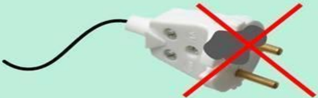
Поврежденная вилка шнура
