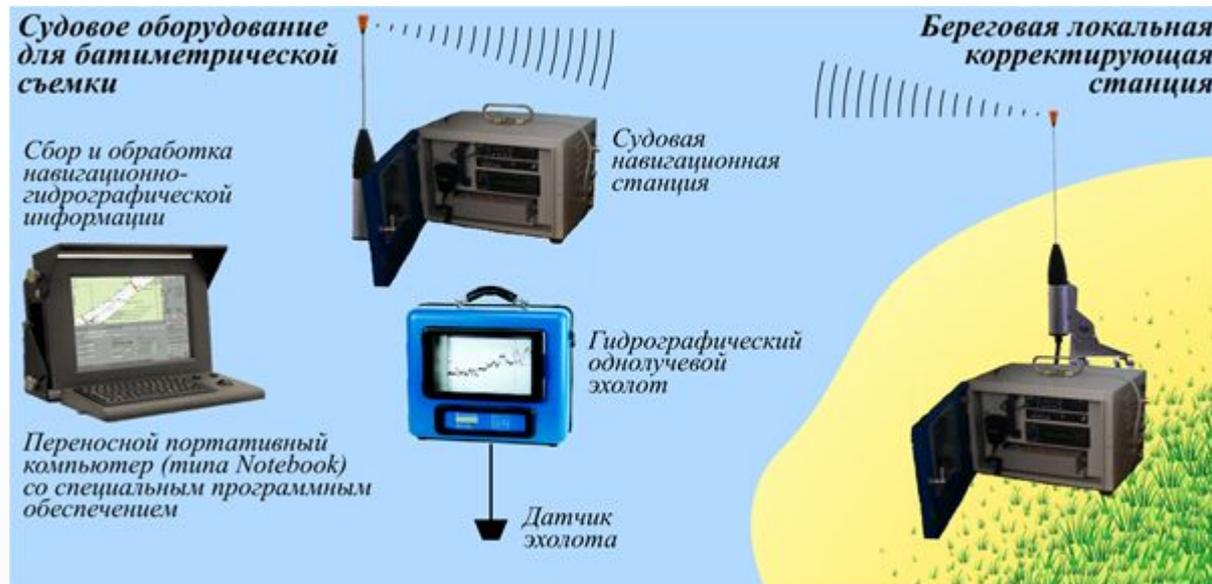
Функциональная схема промерного
