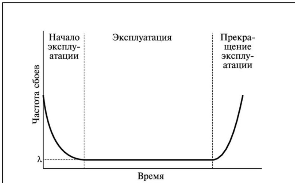
Рис. 2 U-образная кривая надежности аппаратного обеспечения
