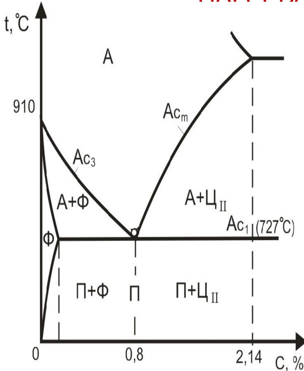
$\text{Ac}_1$  – критическая точка перлитного превращения.  $727^\circ\text{C}$  (линия PSK). При этой температуре происходит перекристаллизация перлита в аустенит ( $\text{П} \rightarrow \text{А}$ ).
