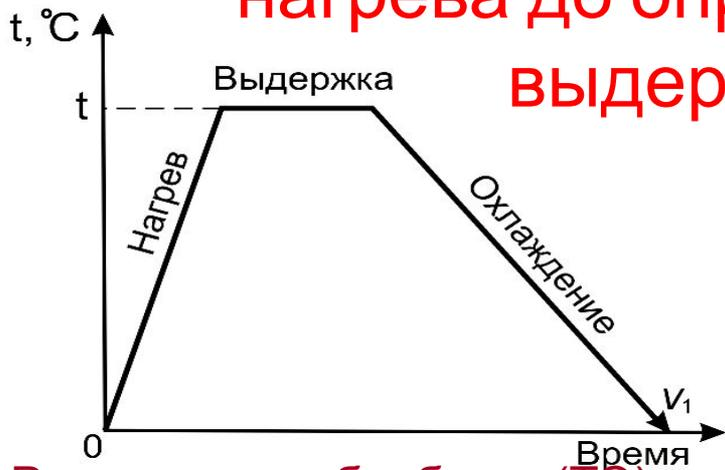
Режим термообработки (ТО) представляется графиком в координатах температура – время. Он характеризуется параметрами:
