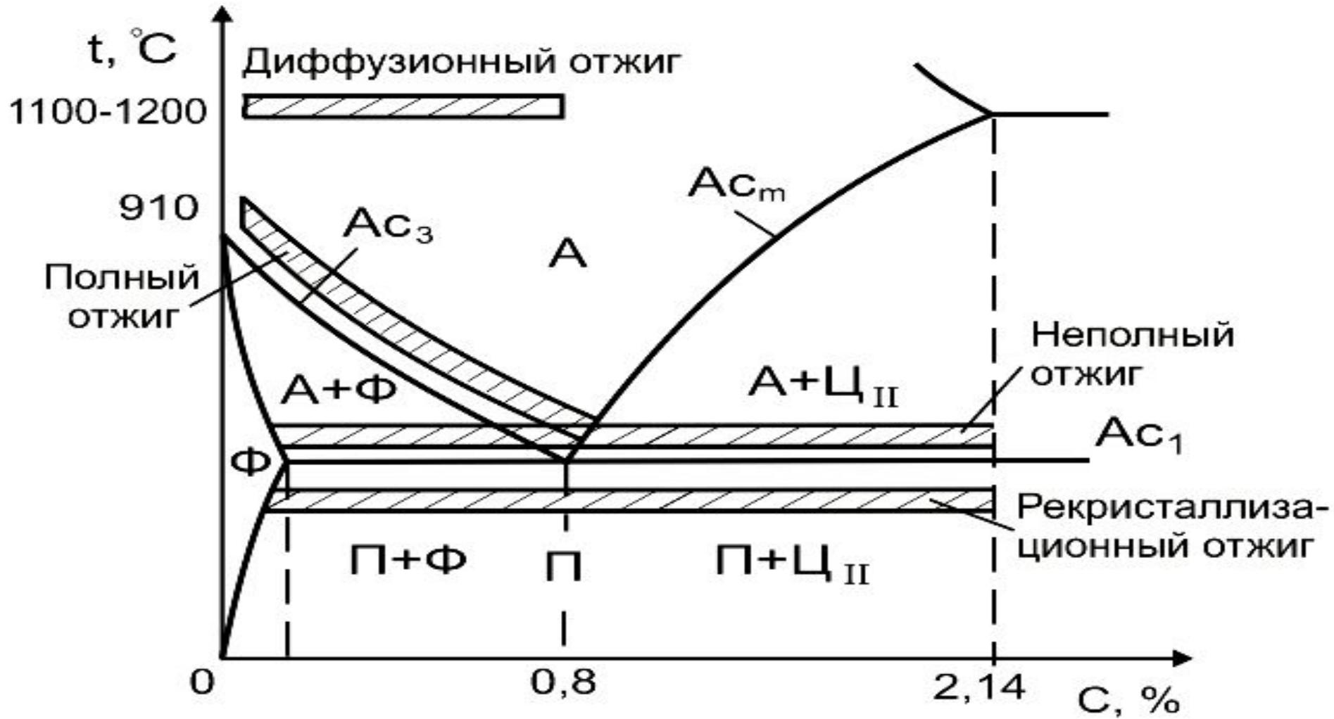
**ЗАКАЛКА** - операция ТО, заключается в нагреве стали до температуры выше полиморфных превращений (доэвтектоидных сталей на 30 - 50°С выше  $A_{c3}$  (полная), заэвтектоидных на 30 - 50°С выше  $A_{c1}$ ), (неполная) выдержке и последующем охлаждении со скоростью выше критической, с целью получения мартенситной структуры, обеспечивающей максимальную твердость, прочность и износоустойчивость (не является окончательной операцией термической обработки)
