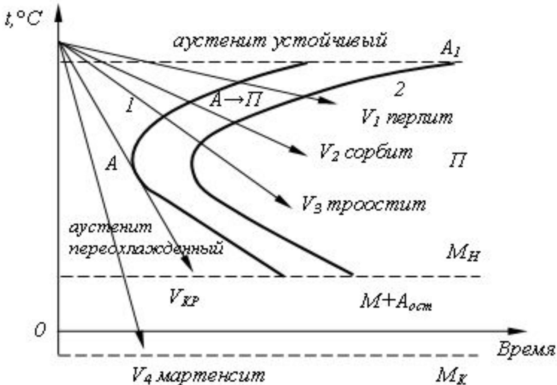
**ПОСЛЕОТЖИВЛЕНИЯ** (нормализационный отжиг) — операция ТО, связанная с нагревом стали до аустенитного состояния, выдержки при температуре нагрева и последующего **охлаждения на воздухе** (получаются следующие структуры: **сорбит+феррит в доэвтектоидных сталях (С+Ф); сорбит в эвтектоидных сталях (С); сорбит+вторичный цементит в заэвтектоидных сталях (С+Ц<sub>II</sub>)**)
