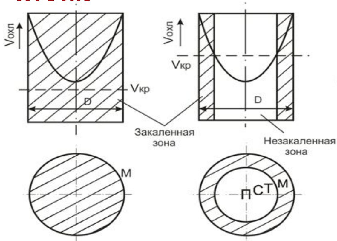
**Закаливаемость** – это способность стали повышать твердость в результате закалки (чем больше в мартенсиде углерода, тем выше его твердость).
