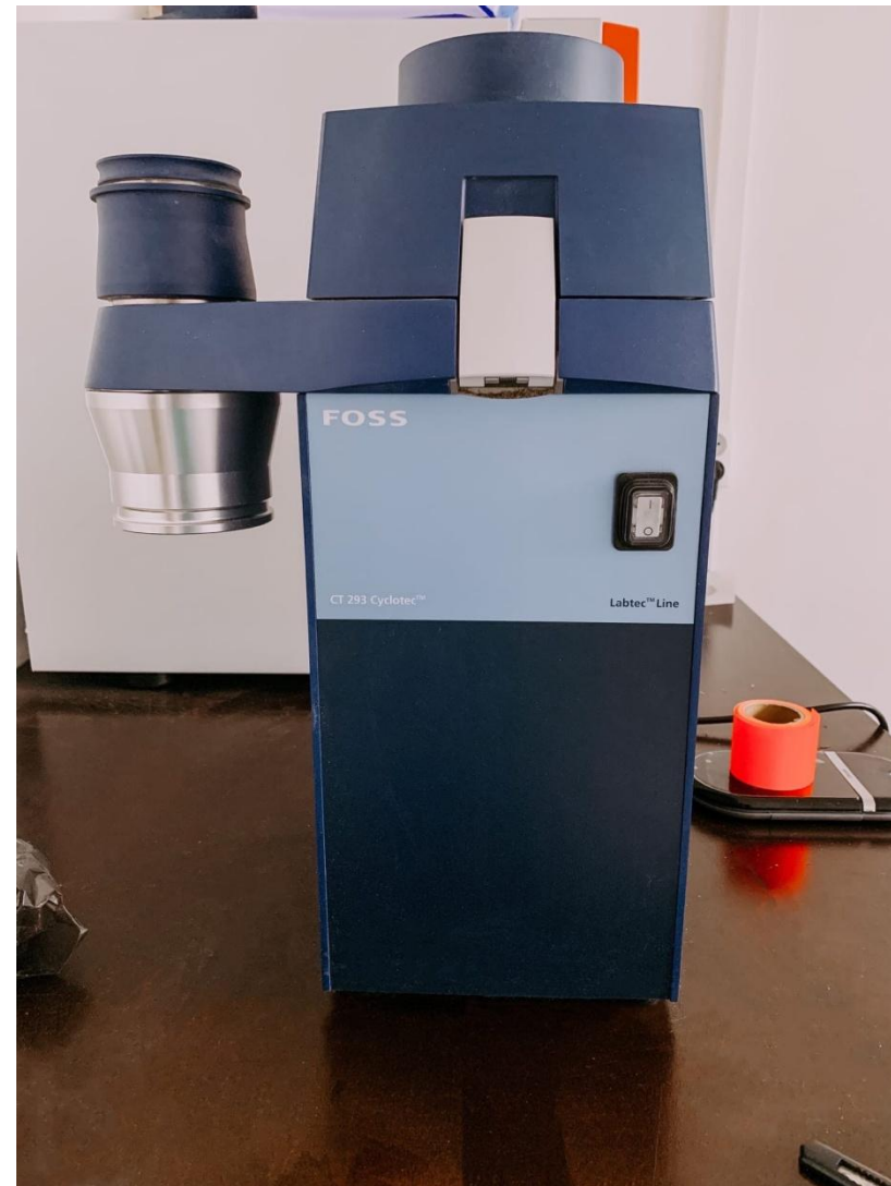
Помол зерен и силосов в мельнице FOSS CT 293 Cyclotec
