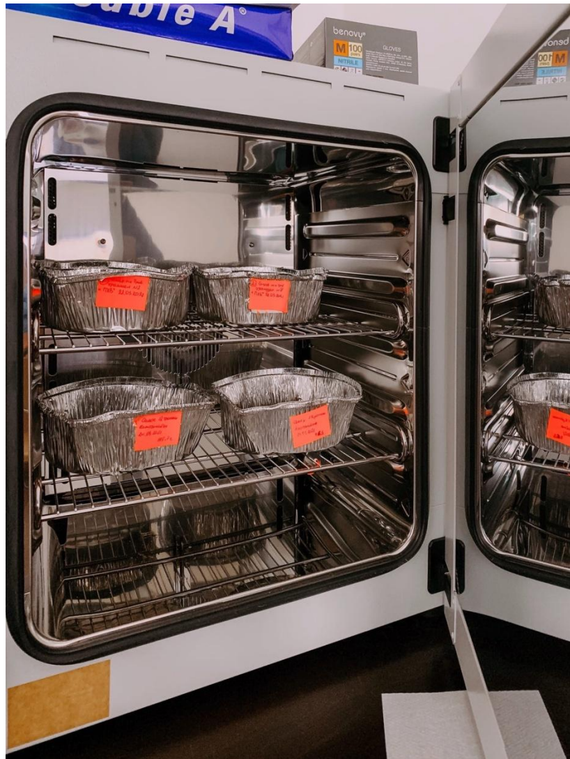
Предварительная сушка кормов в сухожаровом шкафу с принудительной конвекцией
