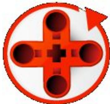
Блок «Вращение мотора» подсчитывает количество градусов (в одном обороте 360 градусов) или полных оборотов вала мотора.
