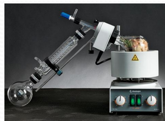
Роторный испаритель для очень бережного испарения, чтобы уловить деликатные ароматы блюд и жидкостей, содержащих летучие эфирные масла;
