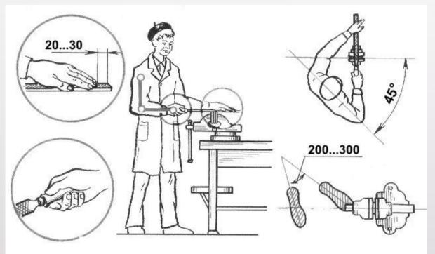
Выполняя опиливание, надо занимать правильную рабочую позу (рис. слева): стоять следует вполоборота к верстаку на расстоянии 150...200 мм от его переднего края, левую ногу выставляют вперед по направлению движения напильника. Закругленная часть ручки напильника должна упираться в ладонь правой руки. Четырьмя пальцами обхватывают ручку, а большой палец накладывают сверху и прижимают к ручке. Вытянутые пальцы левой руки КЛАДУТ НА НОСОК НАПИЛЬНИКА, ОТСТУПИВ ОТ края на 20...30 мм.
