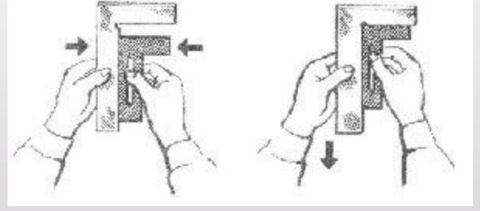
Работать можно напильником с исправной и прочно насаженной ручкой. По окончании работы напильники следует очищать ОТ ПЫЛИ, ОПИЛОК, ГРЯЗИ, масляных веществ. Напильники хранят так, чтобы их насечки не соприкасались друг с другом. Опилки с поверхности изделия надо удалять специальной щеткой.
