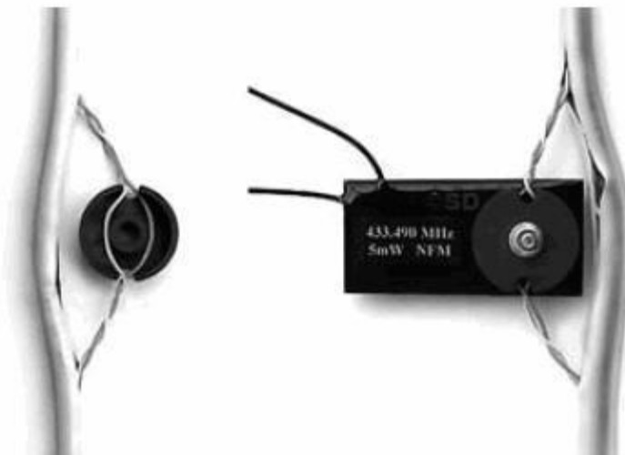
Подключение телефонной радиозакладки к линии с использованием индукционного датчика
