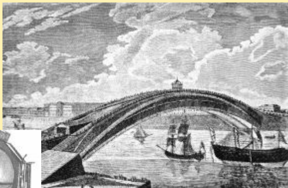
Проект одноарочного деревянного моста через Неву
