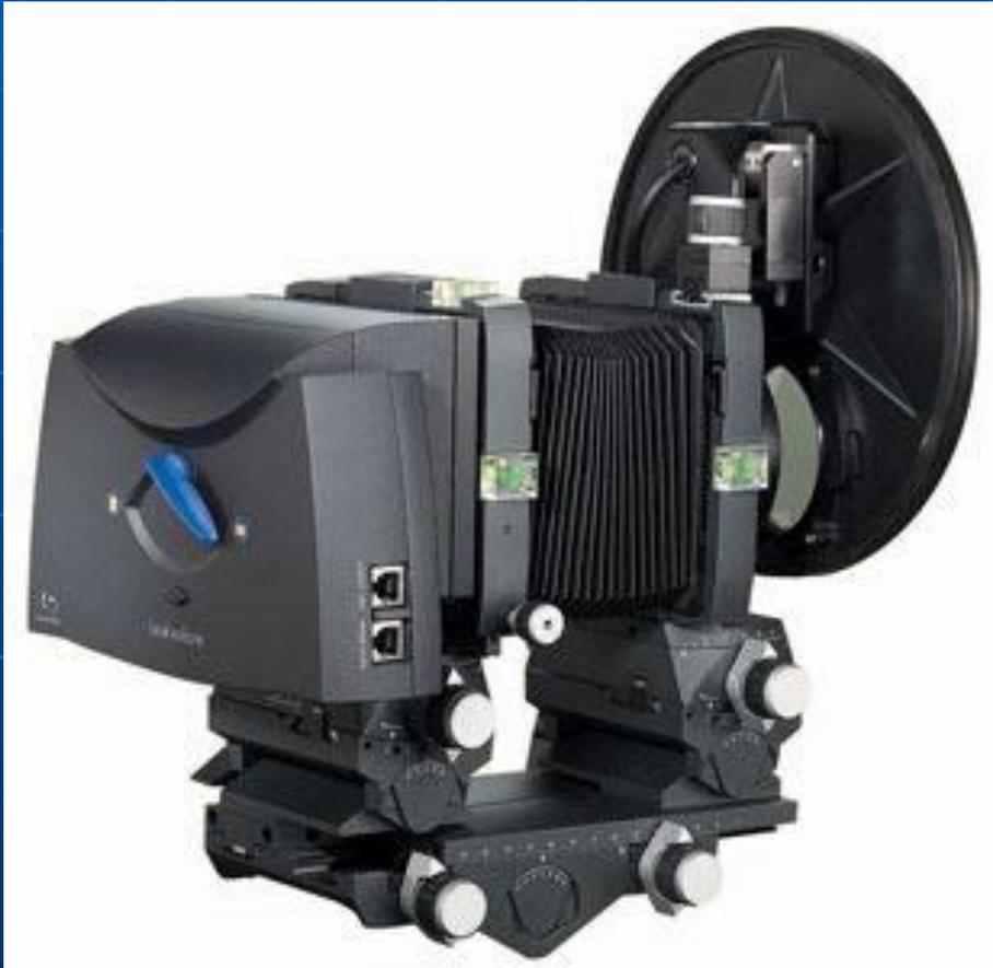
Основаны на трехкратном экспонировании объекта. Для цветоделения применяют красный, синий и зелёный светофильтры. Их смена осуществлялась с помощью цветового диска, в радиально расположенных отверстиях которого они размещаются.
