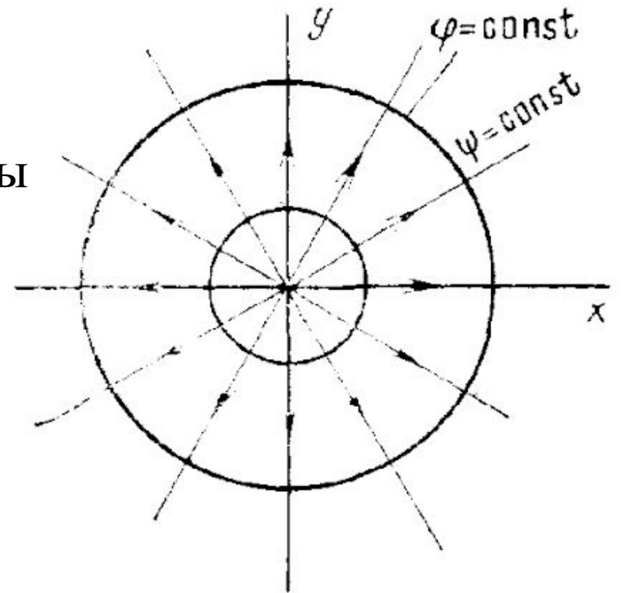
Рис. 4.4. Линии тока и эквипотенциали точечного источника
