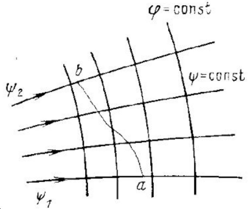
Рис. 4.3. Ортогональная сетка линий тока и эквипотенциалей
