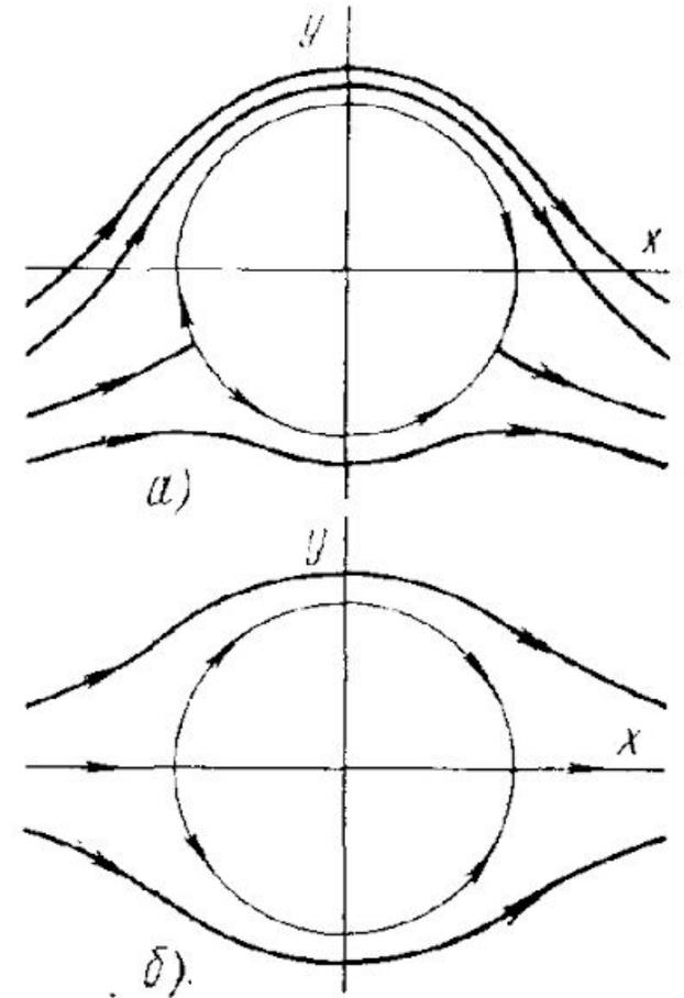
Рис. 4.7. Линии тока при обтекании цилиндра с различной величиной циркуляции:
