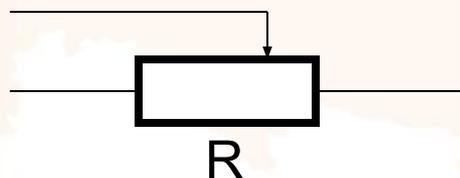
**реостат (проволочная катушка (резистор) с ползунковым токоснимателем). Используется в схемах управления напряжением источников тока**
