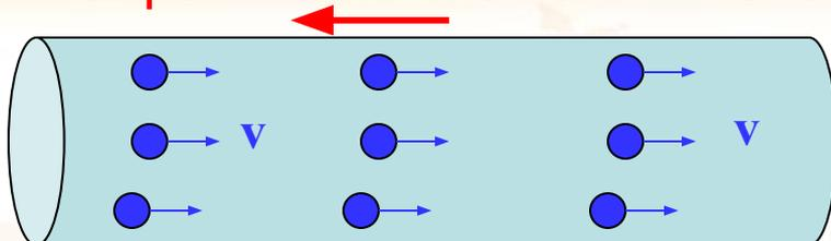
**Электрический ток** – направленное упорядоченное движение свободных электрических зарядов (носителей тока) в веществе под действием внешнего электрического поля.
