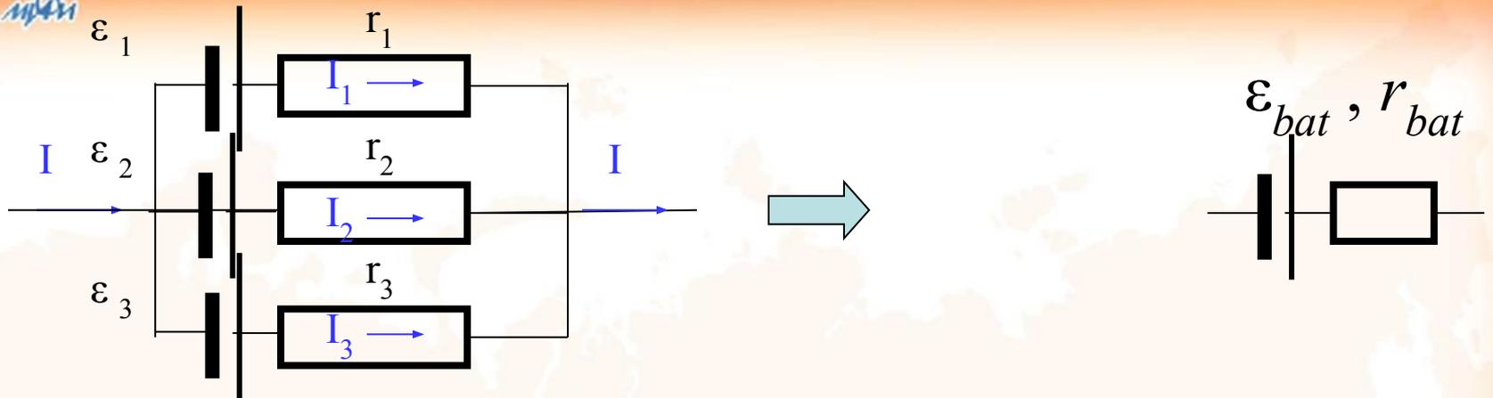
При параллельном соединении элементов Э.Д.С. все не так просто:
