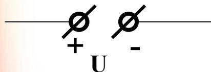
Источник постоянного напряжения  $U$ . Внутреннее сопротивление такого источника можно не учитывать.
