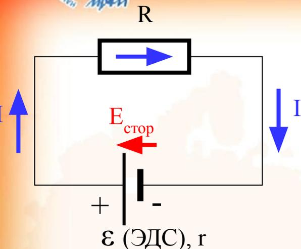
Для поддержания постоянного тока нужны *сторонние силы НЕ* электростатической природы, действующие на заряды в электрической цепи против действия поля электростатического, создающего ток. На рисунке – обозначение на схеме элемента создающего электродвижущую стороннюю силу (ЭДС)
