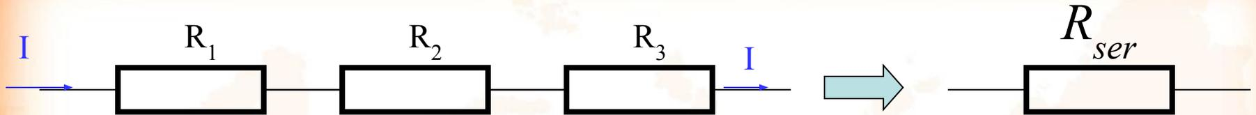
При последовательном соединении резисторов сила тока, протекающего по всем резисторам, одинакова, а разности потенциалов (напряжения), создаваемые на резисторах, складываются
