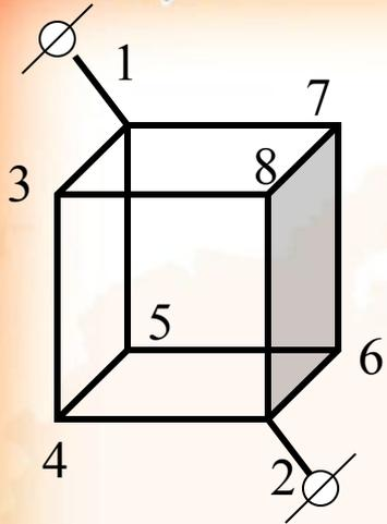
**Задача:** найти сопротивление проволочного куба, включенного в цепь вдоль большой диагонали, если каждое из ребер имеет сопротивление  $r$ .
