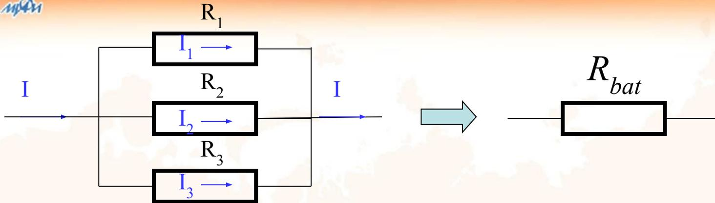
При параллельном соединении резисторов напряжения  $U$ , создаваемые на резисторах, одинаковы. Сила тока в подводящих проводах складывается из токов в параллельно соединенных резисторах:
