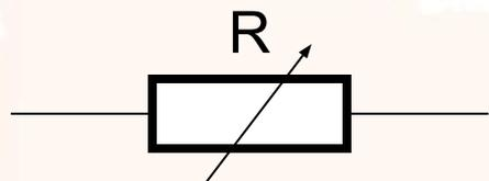
**переменное сопротивление. Элемент схемы с возможностью изменения значения сопротивления  $R$**
