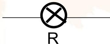
**электролампа (с точки зрения электрической схемы характеризуется сопротивлением  $R$  и потребляемой мощностью  $P$  [Вт])**
