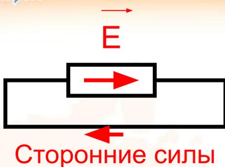
Для существования *длительного* электрического тока необходимо не только наличие свободных заряженных частиц (проводник) и электрическое поле  $E$ , приводящее эти заряды в движение. Необходима также *возможность для зарядов совершать движение по замкнутому контуру*
