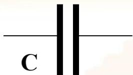
Конденсатор. Элемент схемы с емкостью  $C$ .
