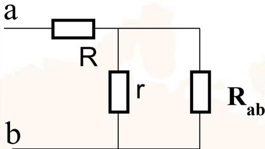
Пару сопротивлений  $r$  и  $R_{ab}$  (соединенных параллельно) можно заменить на
