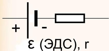
Элемент ЭДС. Элемент схемы, обладающий электродвижущей силой  $\varepsilon$  [В] и внутренним сопротивлением  $r$  [Ом]. Иногда внутреннее сопротивление отображают на схеме отдельно.
