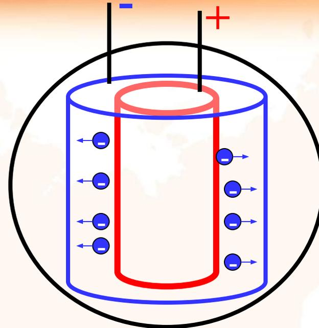
**Источник тока** - устройство, перегоняющее заряды против действия электрического поля с помощью **сторонних сил**.
