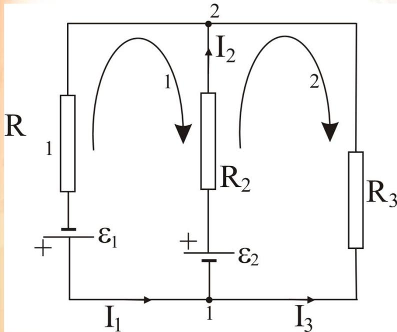
$$\begin{cases} \text{Узел 1} & I_1 - I_2 - I_3 = 0 \\ \text{Контур 1} & -I_1 R_1 - I_2 R_2 = -\varepsilon_1 - \varepsilon_2 \\ \text{Контур 2} & I_2 R_2 - I_3 R_3 = \varepsilon_2 \end{cases}$$
