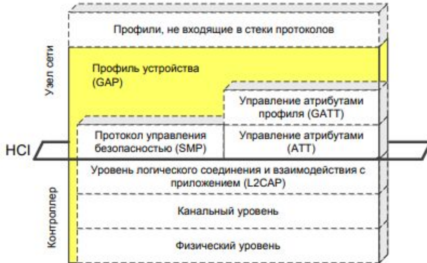
Рис. 5.15 - Структура стека протоколов Bluetooth Low Energy
