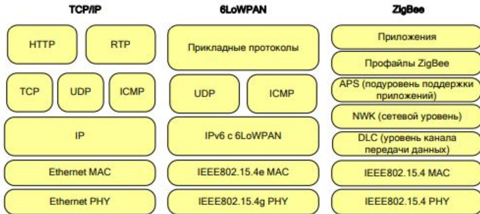
Рис. 5.7 - Сравнение стеков протоколов TCP/IP, 6LoWPAN и ZigBee
