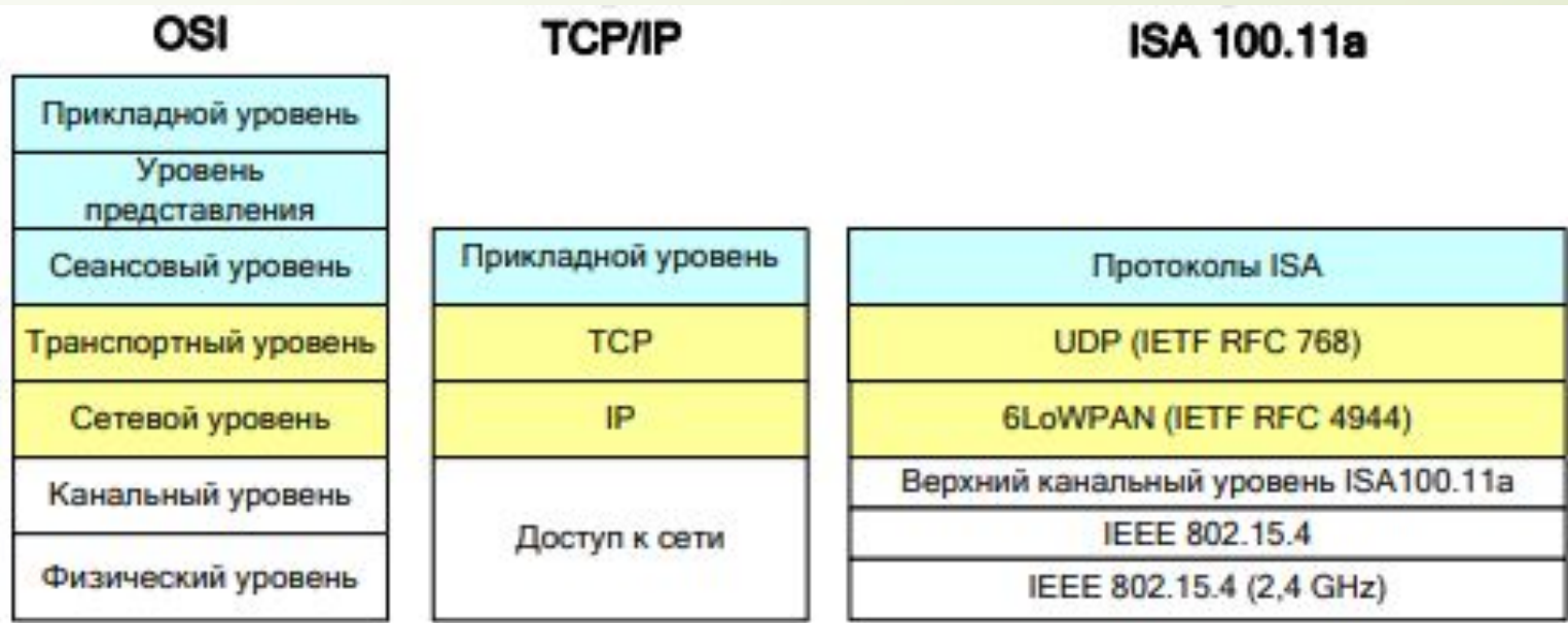
Рис. 5.10 - Сравнение стеков протоколов OSI, TCP/IP и ISA100.11a
