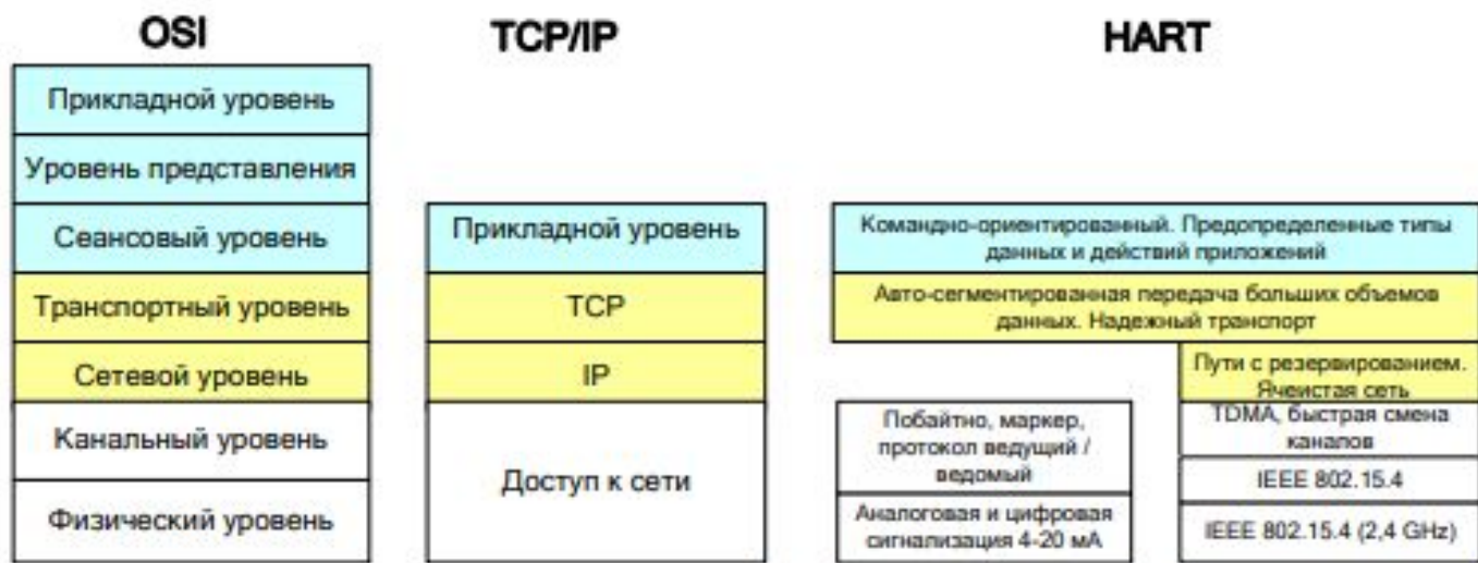
Рис. 5.8 - Сравнение стеков протоколов OSI, TCP/IP и HART
