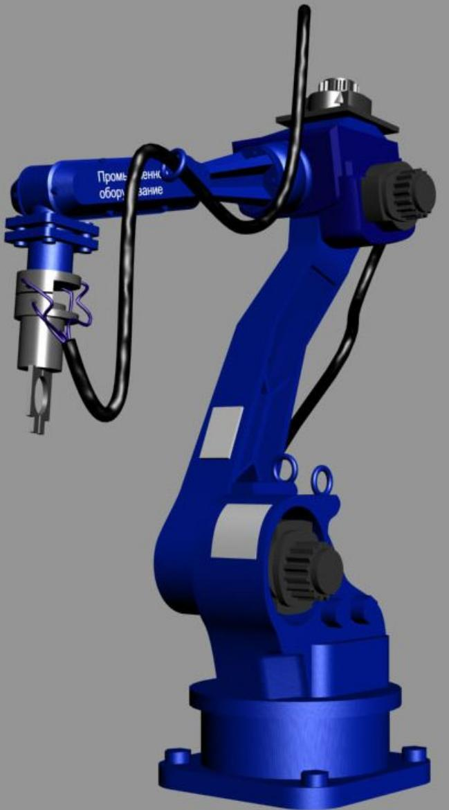
Частью манипуляторов (хотя и необязательной) являются захватные устройства. Наиболее универсальные захватные устройства аналогичны руке человека — захват осуществляется с помощью механических «пальцев».
