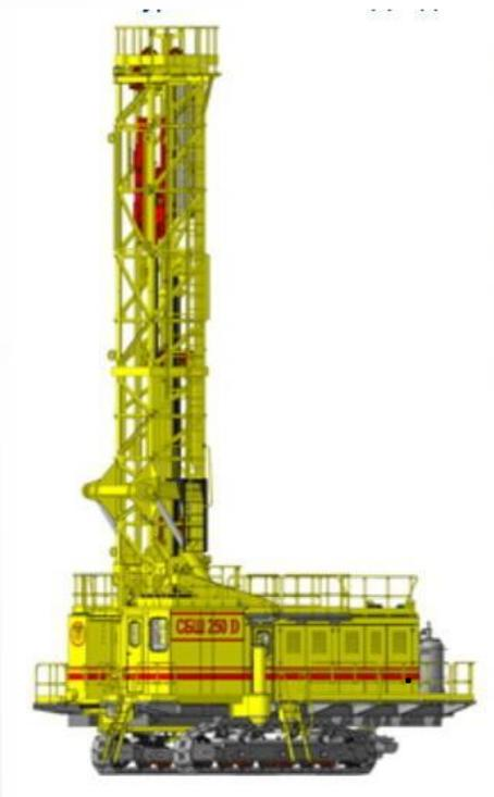
Все буровые установки состоят из следующих основных узлов: вышка или мачта ; механизмы подъёма, вращения и промывки; двигатель с трансмиссией; генераторная и компрессорная установка; контрольно-измерительные приборы; превенторы; вспомогательное оборудование.
