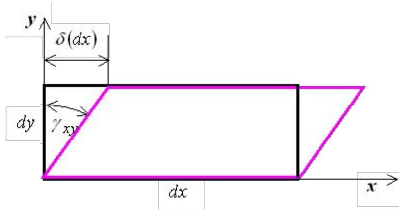
Определим угловую деформацию  $\gamma_{xy}$  как меру изменения прямого угла, в данном случае угла между осями  $x$  и  $y$ :
