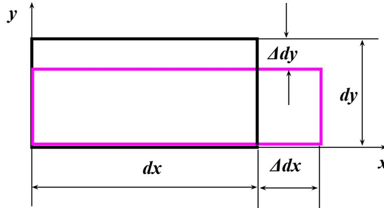
Относительная линейная деформация  $\varepsilon_x$  – это отношение удлинения  $\Delta dx$  отрезка к его начальной длине  $dx$ .
