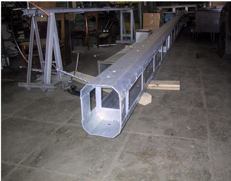
Сборка опор может производиться без специальных приспособлений, это позволяет осуществлять сборку в непосредственной близости от места их монтажа.
