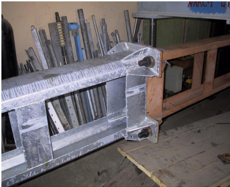
Толщина металлической стенки опоры сокращена до 5 мм (без ущерба для прочности опоры в целом). За счет этого масса опоры снижена до 330 кг.
