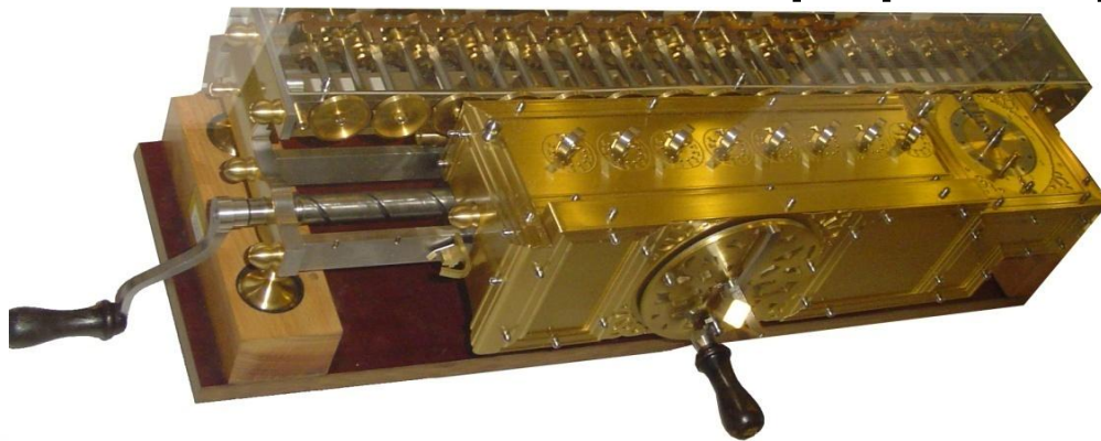
Механический арифмометр Лейбница (1673г.)
