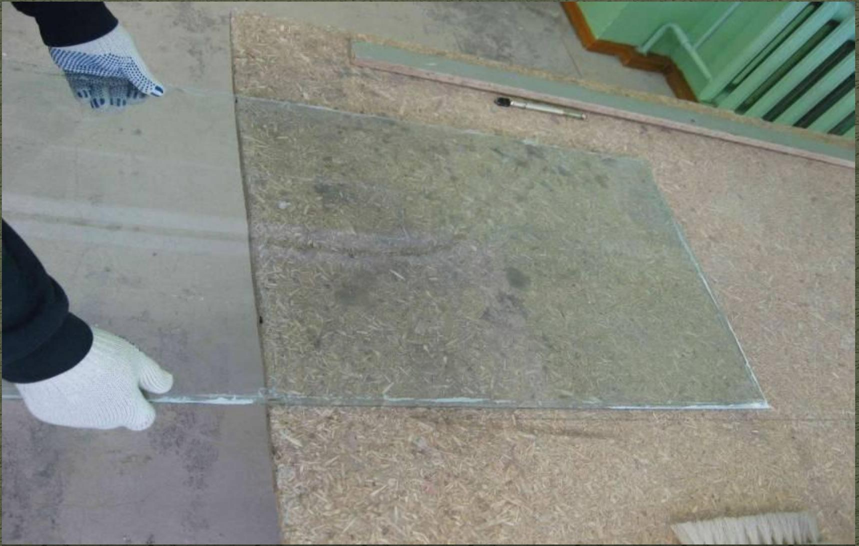
**Совмещаем линию прореза с ровным краем стола. Линия разреза должна быть сверху.**
