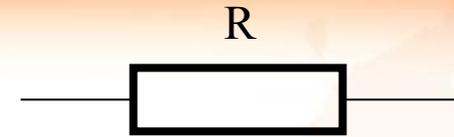
Обозначение проводника с сопротивлением  $R$  (резистора) на электрических[ схемах
