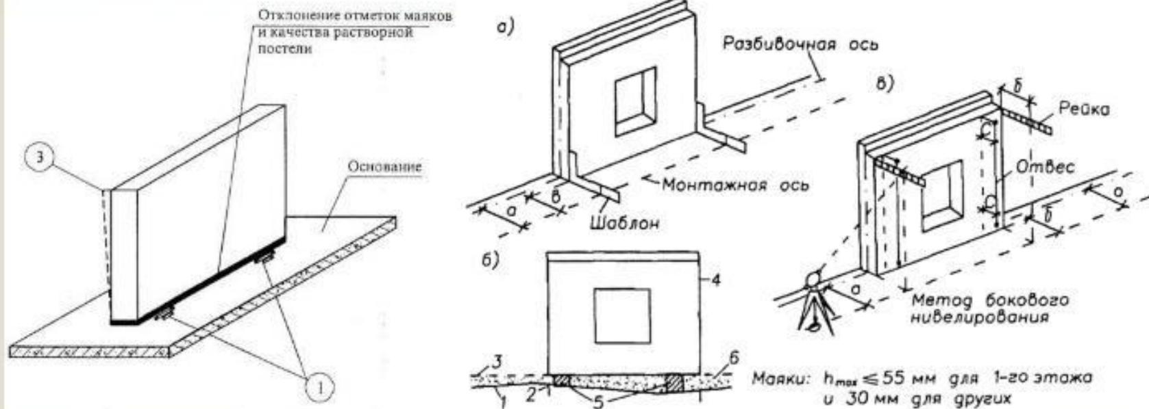
□ Следующий этап **геодезического контроля точности параметров зданий** – контроль монтажа блоков (панелей). В ходе монтажа крупных панелей также осуществляется проверка их планового и вертикального положения. Первое контролируется по совмещению установочных осей с основными осями стен. Вертикальность же блоков проверяется при помощи монтажной рейки
