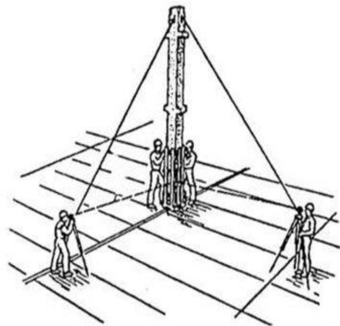
При монтаже всех элементов каркаса следует осуществлять постоянный геодезический контроль за соответствием их положения проектному.
