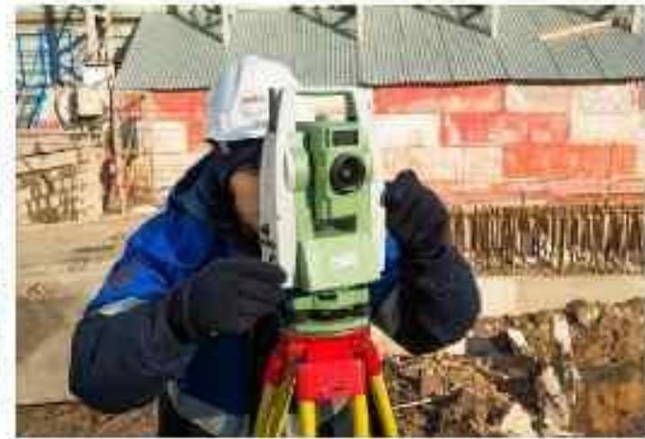
**Перед началом производства полевых работ с использованием теодолита и тахиометра, осуществляют контроль следующих условий (выполняют поверки).**
