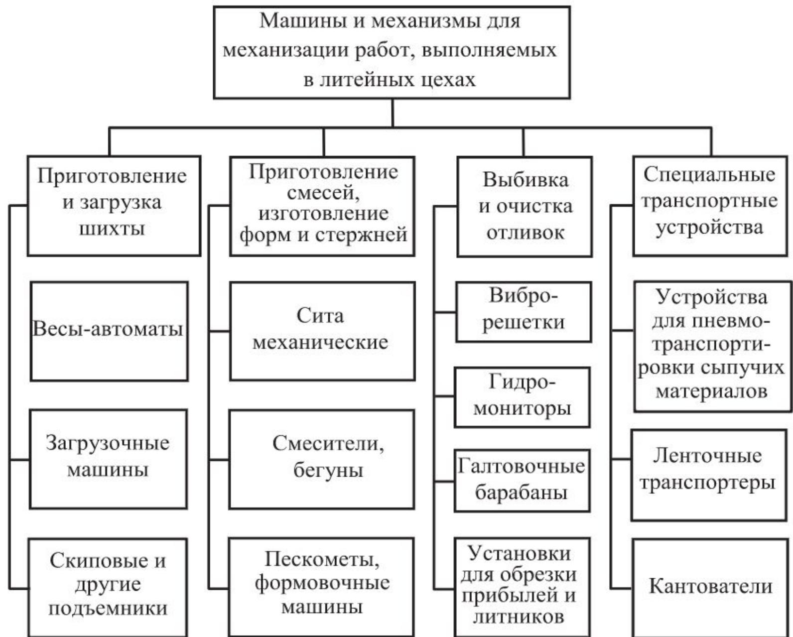
**Рис. 3.1. Классификация машин и механизмов для механизации работ, выполняемых в литейных цехах**
