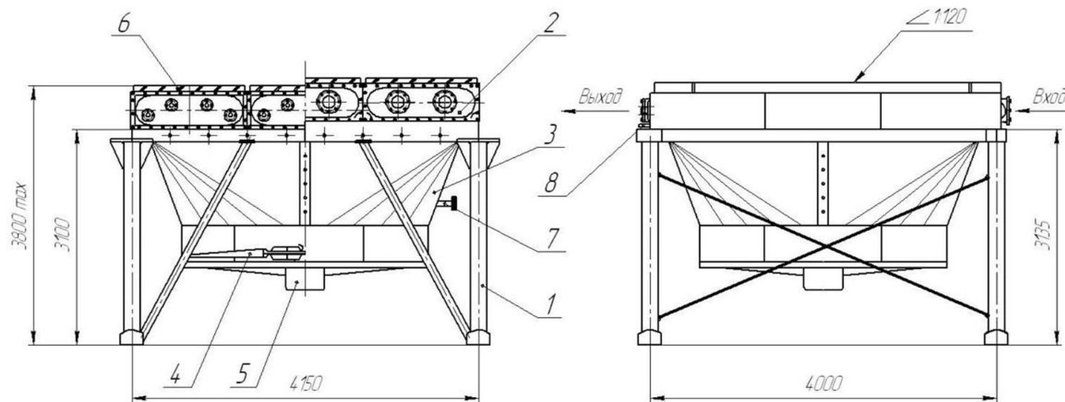
1-металлоконструкция, 2-секция, 3-диффузор,
