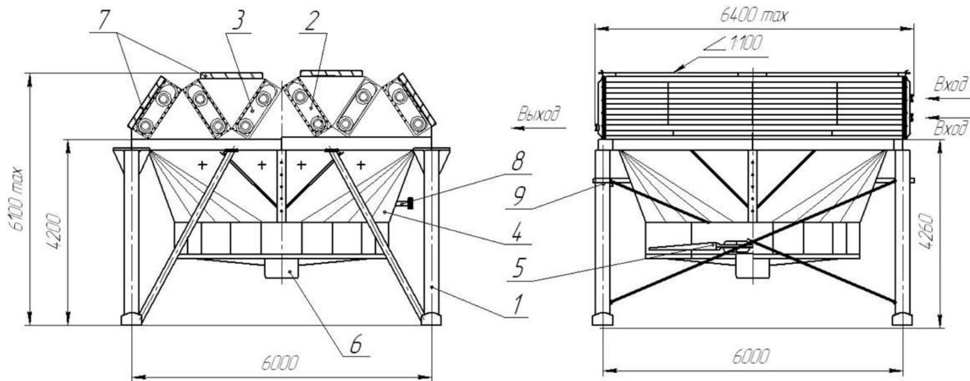
1-металлоконструкция, 2-секция левая, 3-секция правая, 4-диффузор,
