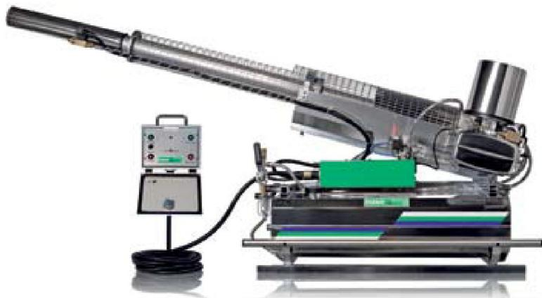
Аэрозольный генератор дает волну тумана шириной 50... 100 м и высотой 7... 10 м. Производительность при обработке садов составляет 15...20 га/ч, при обработке полевых культур — 30...100 га/ч. При работе генератор устанавливают в кузов автомобиля или на тракторную тележку.
