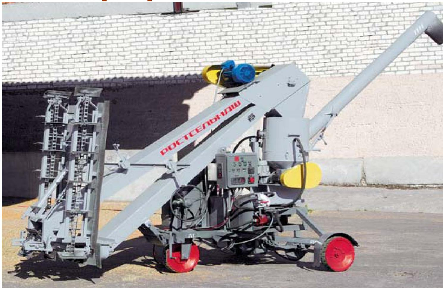
Работа протравливателя заключается в нагнетании и впрыскивании раствора ядохимикатов в зерновую массу с последующим ее перемешиванием и разгрузкой в мешки.
