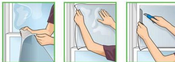
Пленка содержит металлизированный слой, отражающий УФ и ИК-излучение; фильтрация УФ-излучения минимизирует выгорание краски на мебели, а исключение из спектра ИК-диапазона означает, что в жаркую погоду стекло уменьшает передачу тепла в помещение. Зимой благодаря специальным технологиям пленка играет теплосберегающую роль, не давая теплу покидать помещение через окна. Косвенные достоинства такой пленки - улучшение микроклимата помещения, уменьшение вероятности простудных заболеваний летом.
