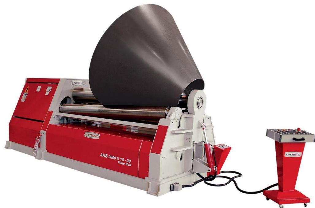
Четырехвалковая схема отличается от трехвалковой тем, что здесь при определенных диаметрах валков могут отсутствовать недовальцованные участки при неподвижных валках.
