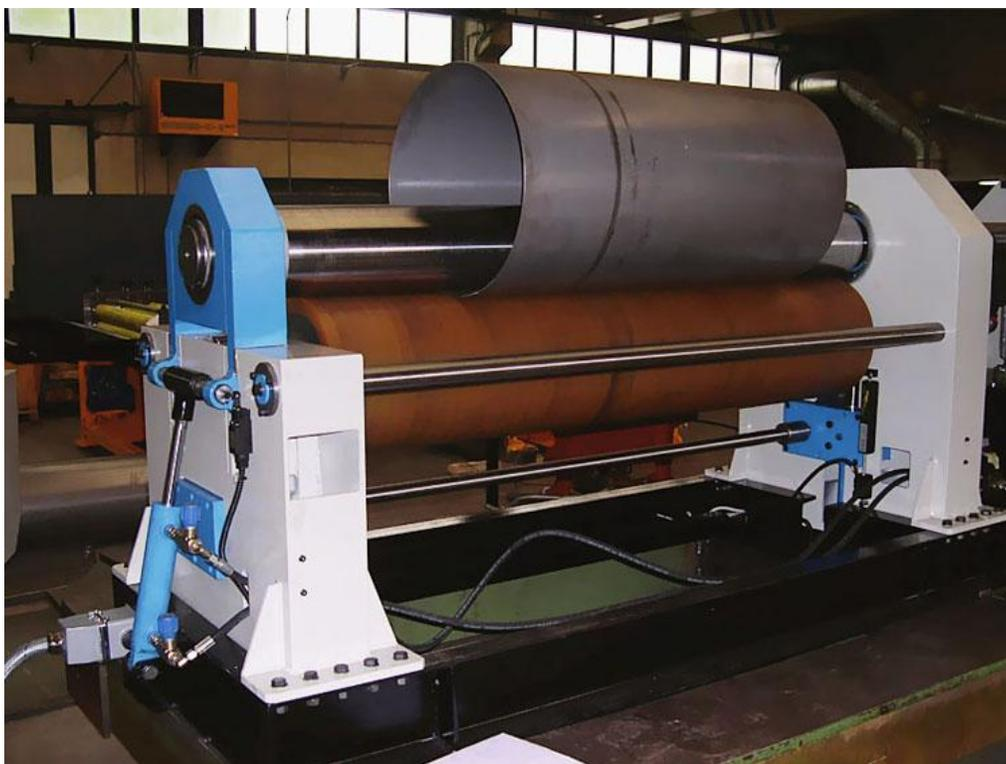
Двухвалковая схема вальцевания возможна в том случае, если один из валков с поверхности податлив, за счет чего осуществляется вальцевание. При этом один из валков изготавливается комбинированным: внутренний слой стальной, а наружная поверхность определенной толщины изготавливается из пластичного материала - полиуретана.
