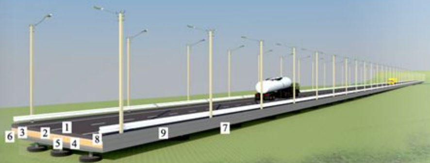
ЭКСПЕРИМЕНТАЛЬНАЯ ЗАСЫПНАЯ СВАЙНО-ЭСТАКАДНАЯ АВТОМОБИЛЬНАЯ ДОРОГА
