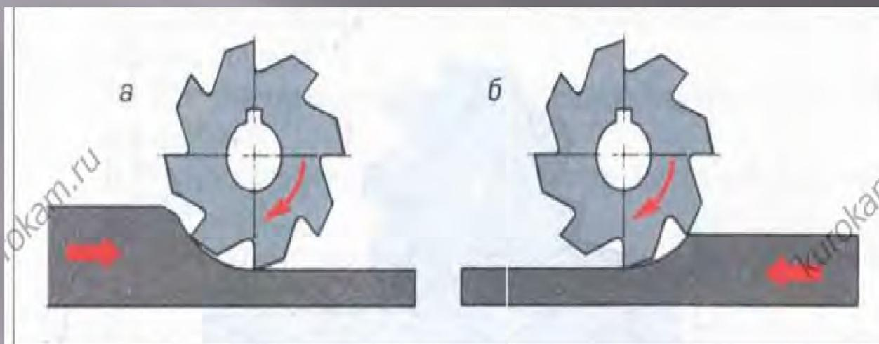
Рис. 96. Виды фрезерования: *a* – встречное, *б* – попутное
