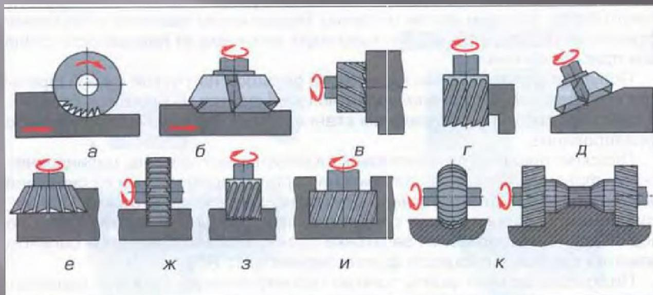
*Рис. 95.* Разновидности операций фрезерования:
