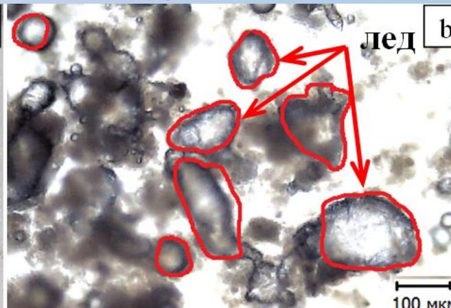
Рис. 15 Исходная (a) и замороженная (b) “сухая вода” с содержанием гидрофобного аэросила 10 мас. %
