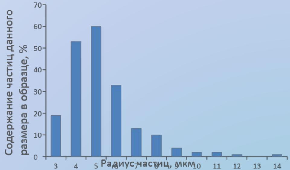
Рис. 8 Гистограмма распределения водных частиц в образце “сухой воды” с содержанием аэросила 5 мас. %
