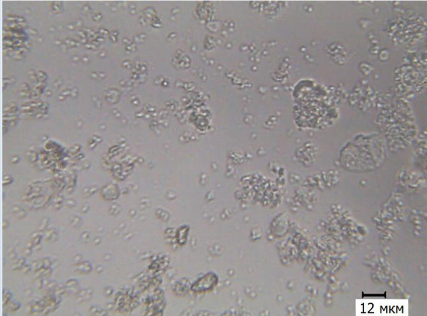
Рис. 7 “Сухая вода” с содержанием аэросила 5 мас. %
