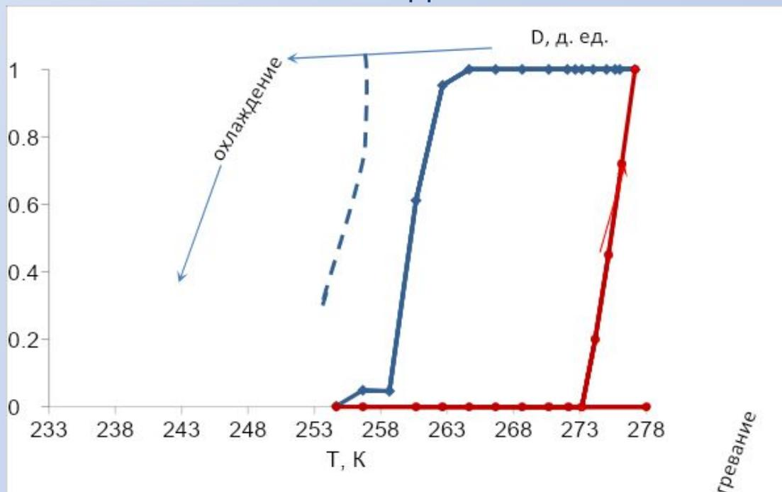
Рис. 12 Изменение доли жидкой воды (по отношению к суммарному ее содержанию) при охлаждении, нагревании образца “сухой воды” (сплошная линия), образца объемной воды (прерывистая линия). Содержание аэросила в “сухой воде” 5 мас. %. Скорость изменения температуры 0,2 К/мин. Содержание воды 0,25 г.
