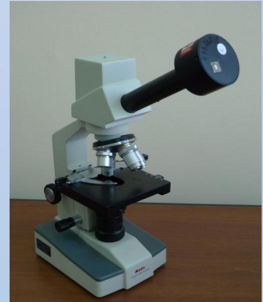
Рис. 5 Цифровой оптический микроскоп
