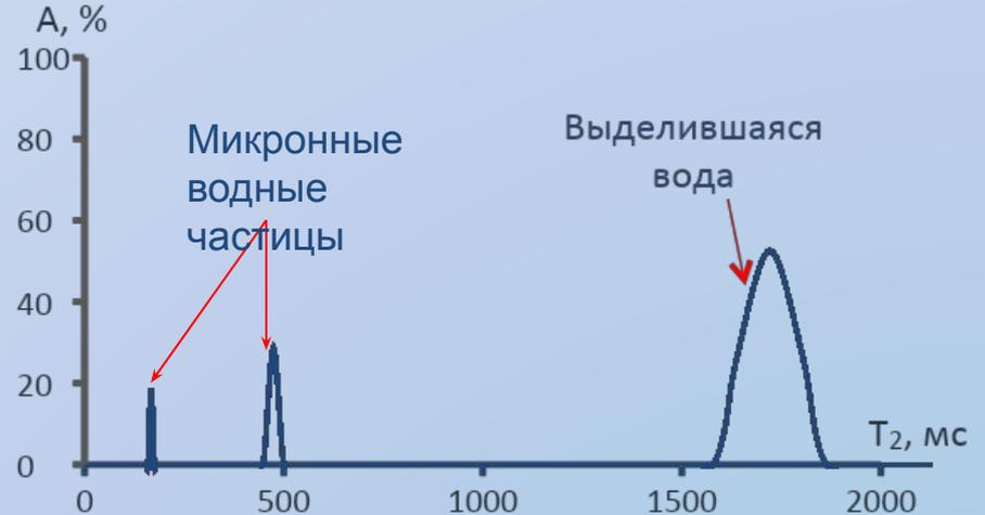
Рис. 10 Спектры времени релаксации  $T_2$  “сухой воды” с содержанием гидрофобного аэросила 5 мас. % после цикла заморозания/оттаивания
