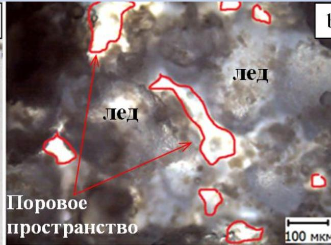
Рис. 14 Исходная (a) и замороженная (b) “сухая вода” с содержанием гидрофобного аэросила 3 мас. %
