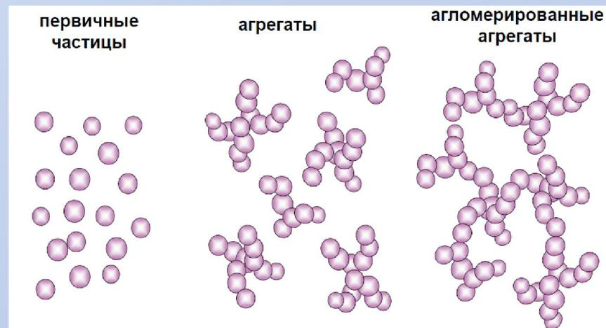
Рис. 2 Частицы гидрофобизированного нанокремнезема
