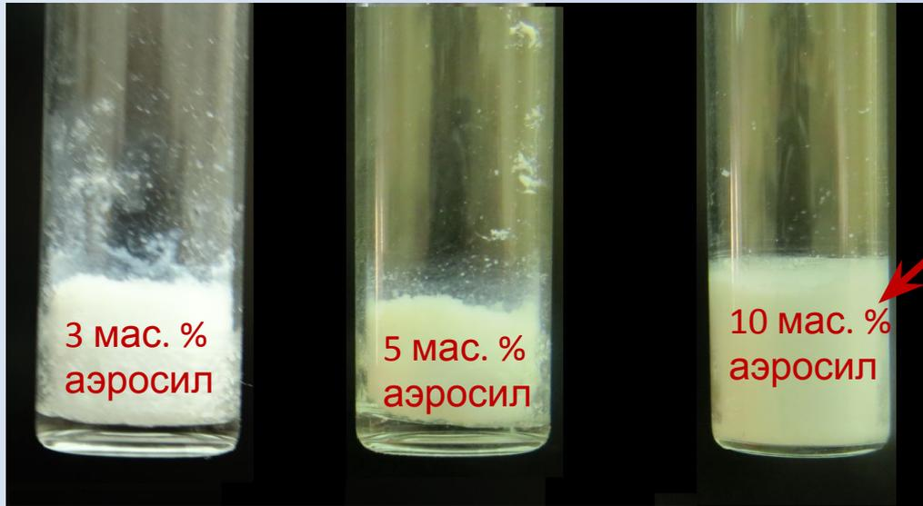
“Сухая вода” с содержанием гидрофобного аэросила 10мас.% не расслоилась после **двух** циклов заморзания/оттаивания
