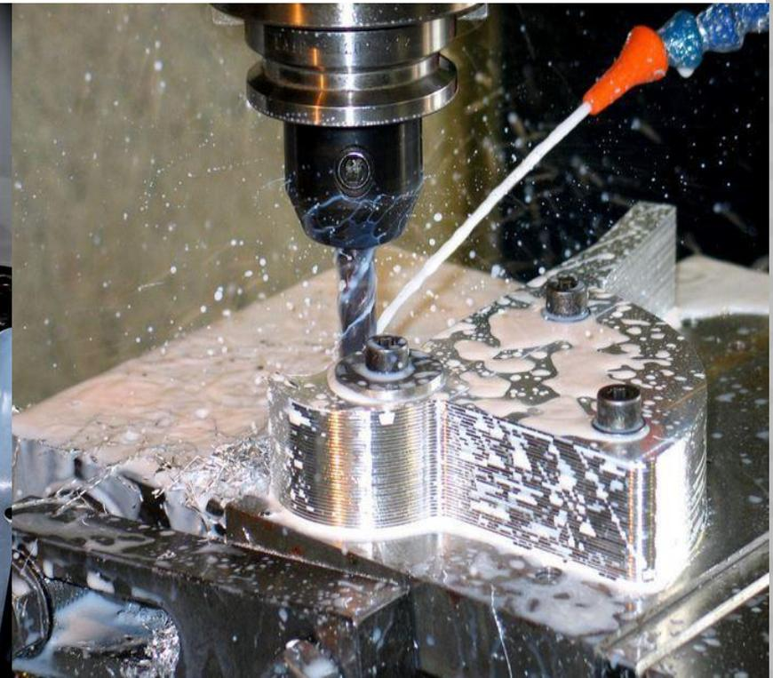
ТИП СВЕРЛИЛЬНО-ФРЕЗЕРНОГО ШПИНДЕЛЯ;
