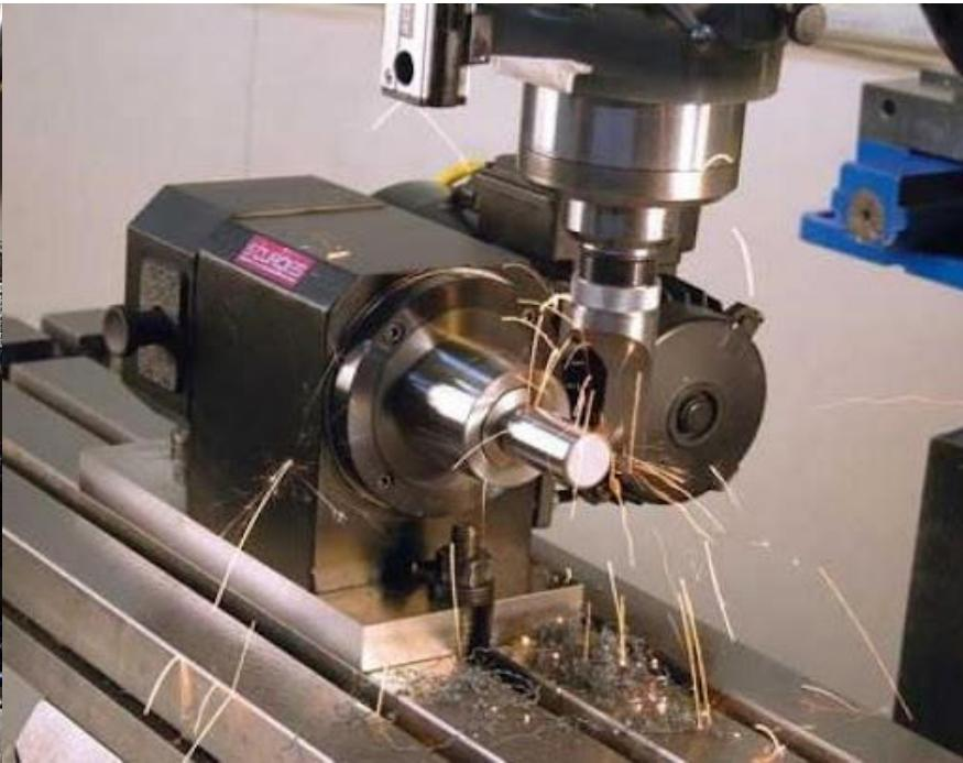
ВЫПУСКАТЬ НЕБОЛЬШОЕ КОЛИЧЕСТВО ЗАПЧАСТЕЙ МОЖНО НА ПРОСТОМ ОБОРУДОВАНИИ ВЕСОМ МЕНЕЕ 1 Т. ВЕРСТАЧНЫЙ ТОКАРНО-ФРЕЗЕРНЫЙ СТАНОК ПРИ ОТНОСИТЕЛЬНО НЕБОЛЬШОЙ СТОИМОСТИ СПОСОБЕН ПРОИЗВОДИТЬ БОЛЬШИЕ ПАРТИИ ДЕТАЛЕЙ, НЕОБХОДИМЫХ ДЛЯ РЕМОНТА АВТОМОБИЛЕЙ, БЫТОВОЙ ТЕХНИКИ И ДРУГИХ МЕХАНИЗМОВ. ОН ВЫПОЛНЯЕТ ОПЕРАЦИИ: ТОЧЕНИЕ ПРОДОЛЬНОЕ И ПОПЕРЕЧНОЕ; СВЕРЛЕНИЕ;
