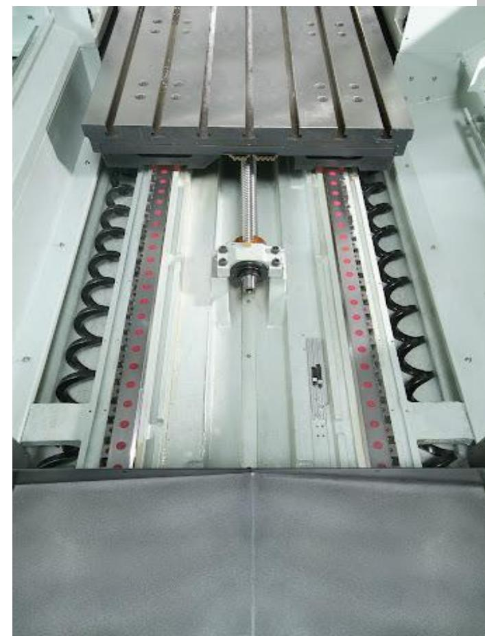
**СТАНИНА ОТЛИТАЯ ИЗ ЧУГУНА ОБРАЗУЕТ ОСТАТОЧНОЕ НАПРЯЖЕНИЕ КОТОРОЕ ПРИВОДИТ КОРОБЛЕНИЮ СТАНИНЫ И НАРУШЕНИЮ ТОЧНОСТИ СТАНКА. ОНА ИМЕЕТ СЛОЖНУЮ, ИНОГДА КОРОБЧАТУЮ ФОРМУ, С ПЕРЕГОРОДКАМИ, РЕБРАМИ И ОКНАМИ; КРУПНЫЕ СТАНИНЫ ДЕЛАЮТ СОСТАВНЫМИ.**
