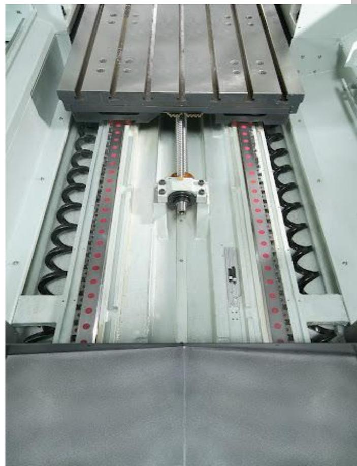
СТАНИНА ОТЛИТАЯ ИЗ ЧУГУНА ОБРАЗУЕТ ОСТАТОЧНОЕ НАПРЯЖЕНИЕ КОТОРОЕ ПРИВОДИТ КОРОВАЖЕНИЮ СТАНИНЫ И НАРУШЕНИЮ ТОЧНОСТИ СТАНКА. ОНА ИМЕЕТ СЛОЖНУЮ, ИНОГДА КОРОБЧАТУЮ ФОРМУ, С ПЕРЕГОРОДКАМИ, РЕБРАМИ И ОКНАМИ; КРУПНЫЕ СТАНИНЫ ДЕЛАЮТ СОСТАВНЫМИ.
