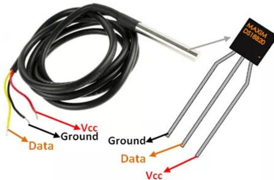
Рисунок 5 – Электронный датчик температуры DS18B20
