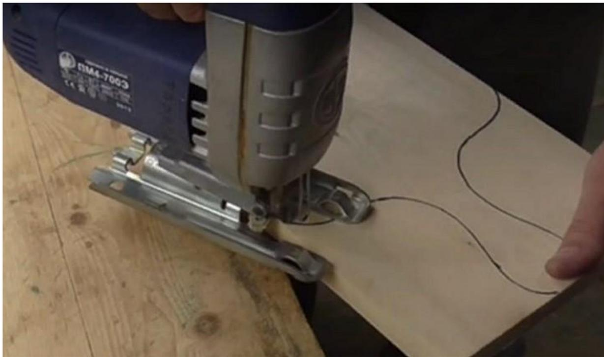
**Шаг 1.**Переносим на деревянную заготовку контур будущего изделия и вырезаем его лобзиком или ножовкой по металлу с мелким зубом – он не делает больших сколов.
